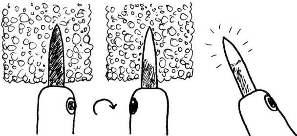
ESTO DEBERÍA DEJAR LA PUNTA PLATEADA Y ALGO BRILLANTE - LISTO PARA SOLDAR. RECUERDA LIMPIAR ASI LA PUNTA ANTES DE CADA CONECCIÓN QUE HAGAS - LAS PUNTAS SE OXIDAN RÁPIDAMENTE! SI LA PUNTA ESTA BONITA, PLATEADA Y BRILLANTE, TU PUEDES HACER BUENAS CONEXIONES.
