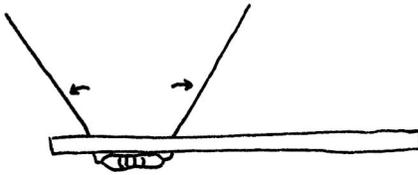
LUEGO DOBLA LOS TERMINALES DE LA RESISTENCIA HACIA AFUERA COMO A 45 GRADOS ASI EL COMPONENTE NO SE CAERÁ MIENTRAS LO SUELDAS EN SU LUGAR.
