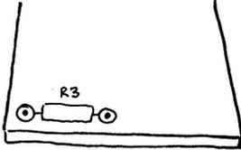
COMO LA PALABRA "RESISTENCIA" EMPIEZA CON LA LETRA "R", LA PLACA USUALMENTE MARCA DONDE SE UBICAN LAS RESISTENCIAS CON UNA "R", SEGUIDO DEL NUMERO DE RESISTENCIA, COMO POR EJEMPLO "R3".
