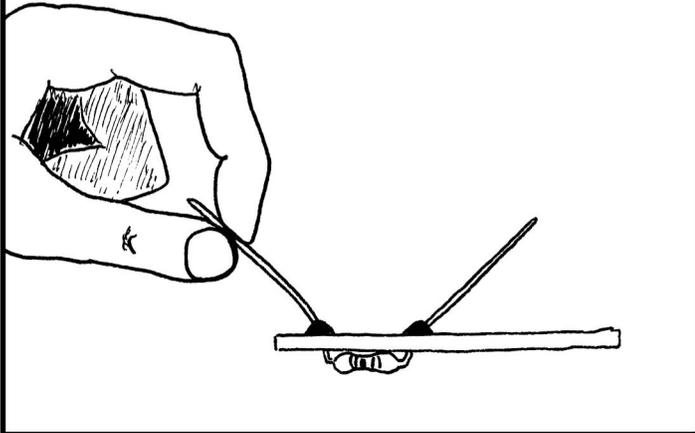
SI EL EXCESO DE TERMINAL ES DEMASIADO CORTO PARA SUJETARLO (PERO SUFICIENTEMENTE LARGO PARA HACER UN CORTOCIRCUITO), ENTONCES POSICIONA ALICATE, PON TU MANO SOBRE EL TERMINAL,
