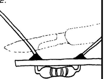
**TIP DE SEGURIDAD #3 (DE 3): SIEMPRE SUJETA EL TERMINAL QUE ESTAS CORTANDO CON UNA MANO, MIENTRAS LO CORTAS CON LA OTRA.**
