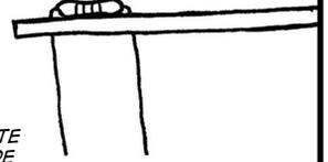
EN LA MAYORÍA DE LAS PLACAS, TODOS LOS COMPONENTES SON COLOCADOS A TRAVÉS DE LAS ISLAS EN EL LADO IMPRESO DE LA PLACA (AL CUAL LLAMAMOS PARTE SUPERIOR DE LA PLACA), Y SOLDAREMOS TODAS LAS ISLAS EN LA PARTE INFERIOR DE LA PLACA.
