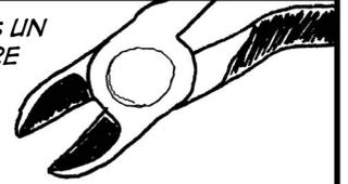
COLOCA EL BORDE PLANO HACIA ABAJO, PARALELO A LA PLACA, JUSTO EN EL EXTREMO DEL BULTO DE ESTANO. PRESIONA EL ALICATE, Y EL BORDE DE CORTE SE CERRARÁ DE GOLPE.
