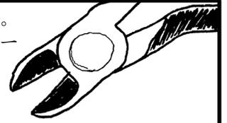
将平坦的刃口朝下，平行于电路板，放到小焊接点的顶端。
